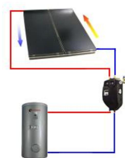
**Figura 22** - Impianto solare termico a circolazione forzata
